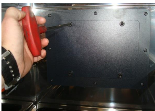
Figura nº19 - Acceso a los tornillos para retirar la tapa de la escotilla
