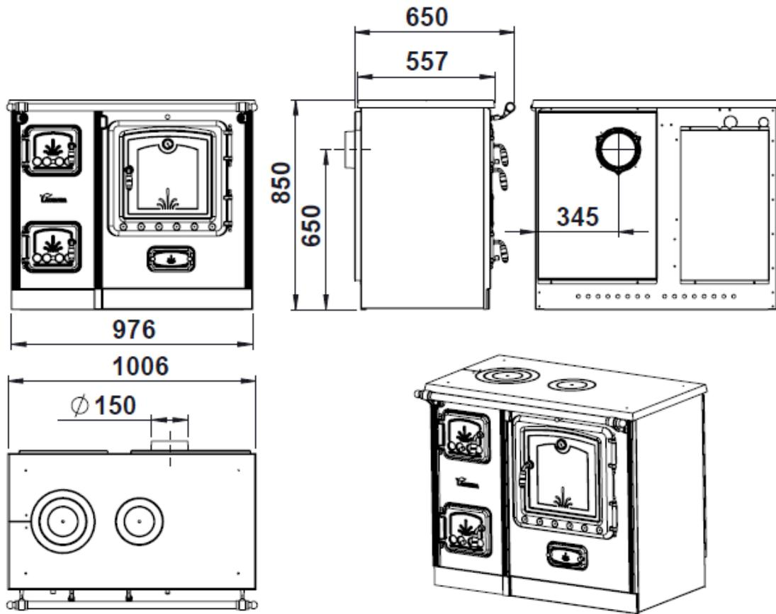
Figura n°3 - Dimensiones en mm del aparato Lis 8T
