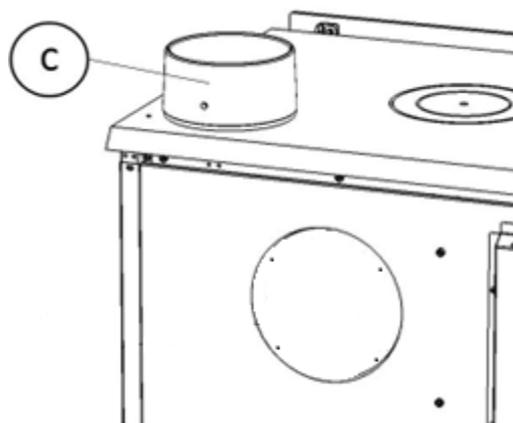
Figura nº8 - Esquema para salida de humos superior
