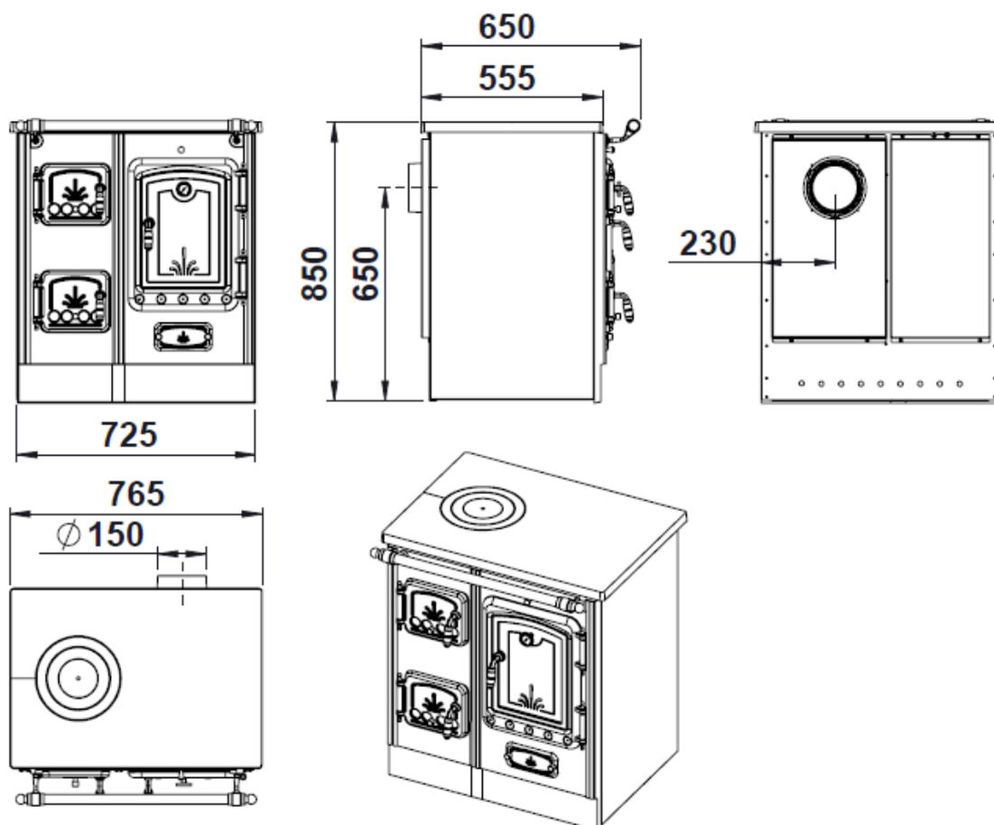
Figura nº1 - Dimensiones en mm del aparato Lis 5T
