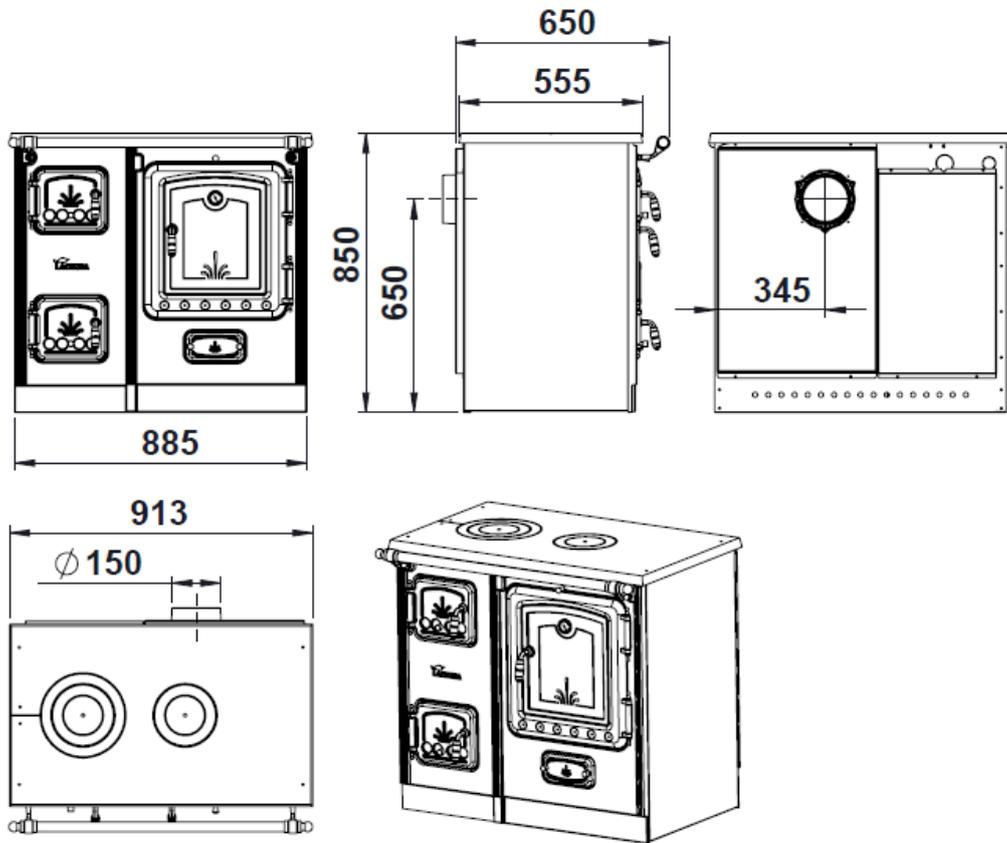
Figura n°2 - Dimensiones en mm del aparato Lis 7T
