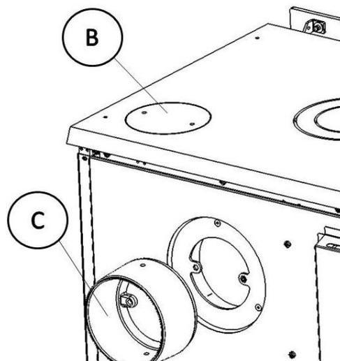
Figura nº7 - Esquema para salida de humos trasera
